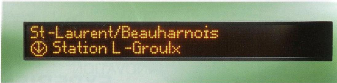
*Darstellungsfreiheit bei bester Lesbarkeit im Fahrzeug – PIDmobil4 von INIT vereint die flexiblen Darstellungsmöglichkeiten eines TFT-Displays mit der hervorragenden Lesbarkeit der LED-Technologie.*
