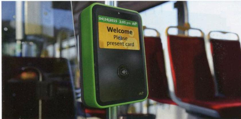
Am PROXmobil3 können die Fahrgäste einfach und bequem ein- und auschecken – dabei wird ihnen immer der optimale Tarif berechnet (INIT).
