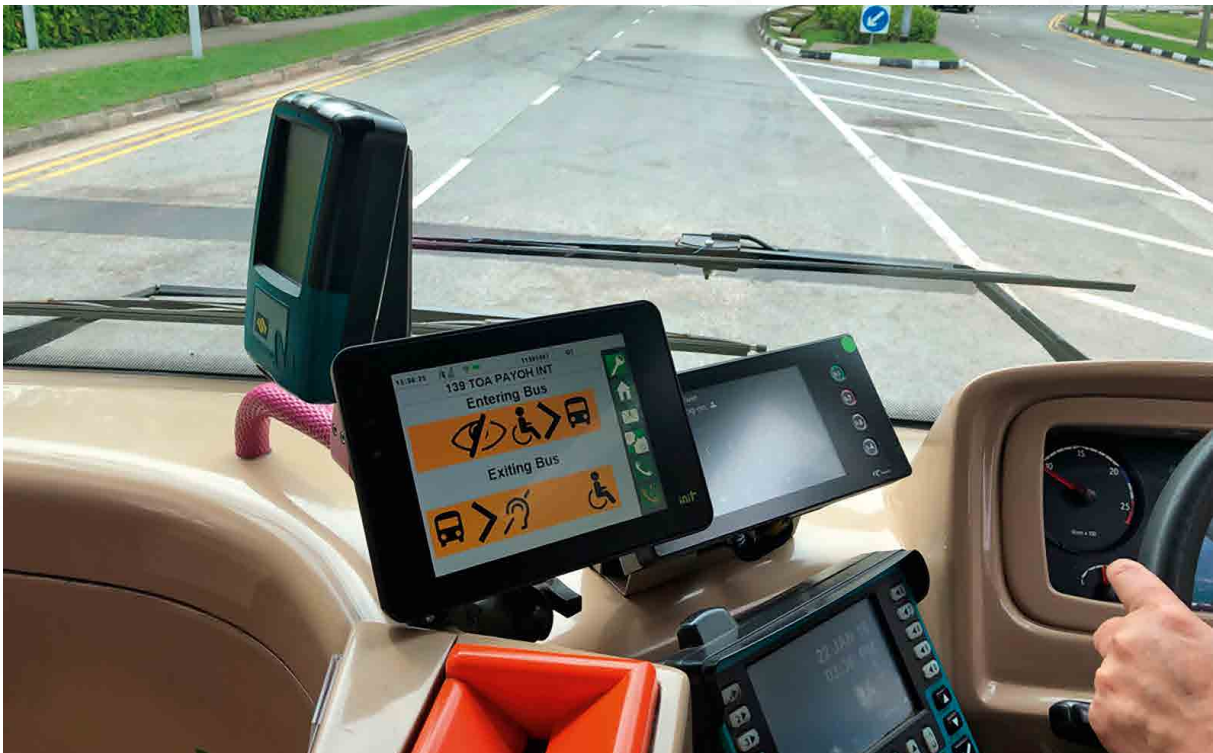
Einzigartig an der init Lösung: Fahrern wird angezeigt, ob Fahrgäste mit speziellen Mobilitätsbedürfnissen ein- oder aussteigen wollen.
